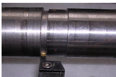
Slika 1.8. Tokarenje profila (utor)
