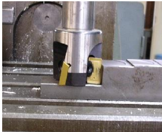
Slika 1.27. Prikaz čeonog glodanja
