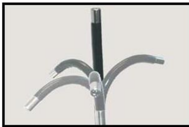
Slika 6.: Mogućnost daljinskog upravljanja vrhom fibroskopa
